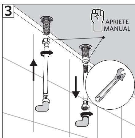
1-Ajustar firmemente los flexibles a los hilos de la grifería, luego, los otros extremos conectarlos a los terminales de la pared, primero con la mano, y después con la llave indicada dar un 1/4 de vuelta, tomando con la mano libre el flexible para que no se enrosque.
