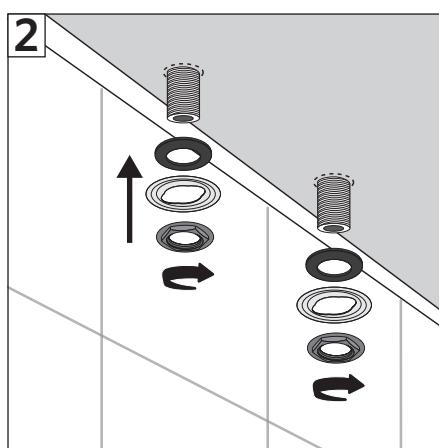
1- Por debajo del lavaplatos instalar las gomas planas y las placas metálicas en el hilo de la grifería.
